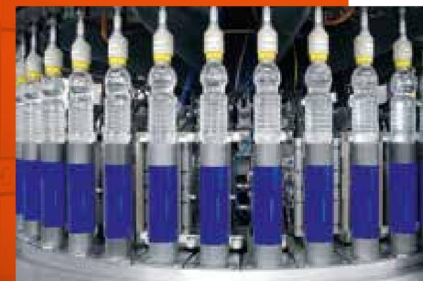
La Roll sleeve offre un cycle continu et contrôle automatiquement le débit des emballages qui entrent dans la machine et en sortent.
