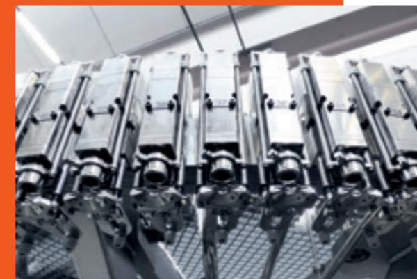
Com controle volumétrico por medidor de vazão magnético, nossos sistemas flexíveis realizam um enchimento preciso sem desperdício de bebida.
