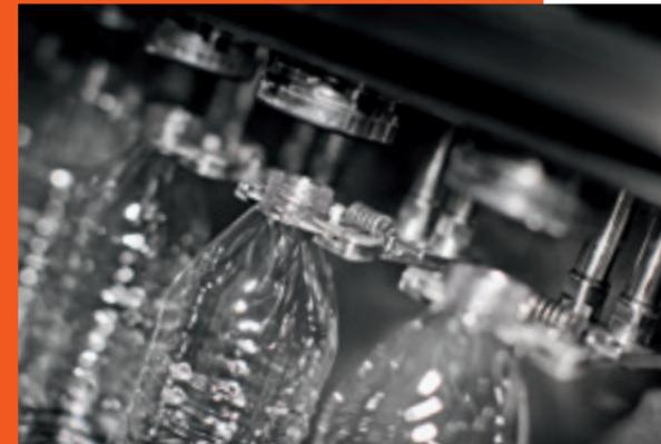
Limpieza interna de las válvulas de llenado, con la utilización de falsas botellas automáticas durante la CIP, lo que genera un ciclo de limpieza más seguro y eficaz.
