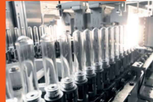
El estiramiento eléctrico permite una alta velocidad con bajo mantenimiento, mientras aún responde a sus necesidades en términos de flexibilidad de producción.
