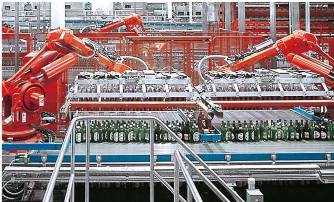
RoboKombi es un sistema utilizable en las líneas de botellas sueltas, de cajas de plástico y fardos trabajando tanto con pisos completos como a fi las. Su capacidad va de 450 ciclos/hora con 600 kg. de carga total a los 550 ciclos/h con 300 kg.
