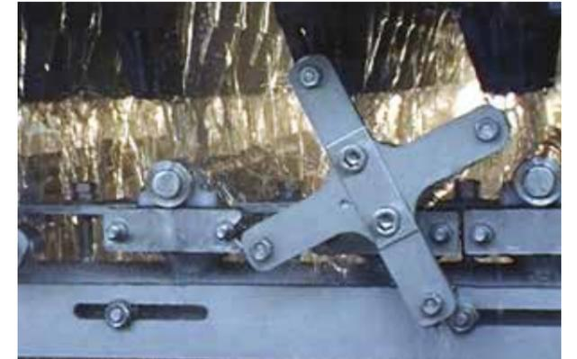
Die Filterleistung kann entsprechend der Größe der Schmutzpartikel durch Filtersäcke unterschiedlicher Maschenweite verändert werden, d.h. größere Maschen für den Vorreinigungsbereich und kleinere Maschen für den Spülbereich.
