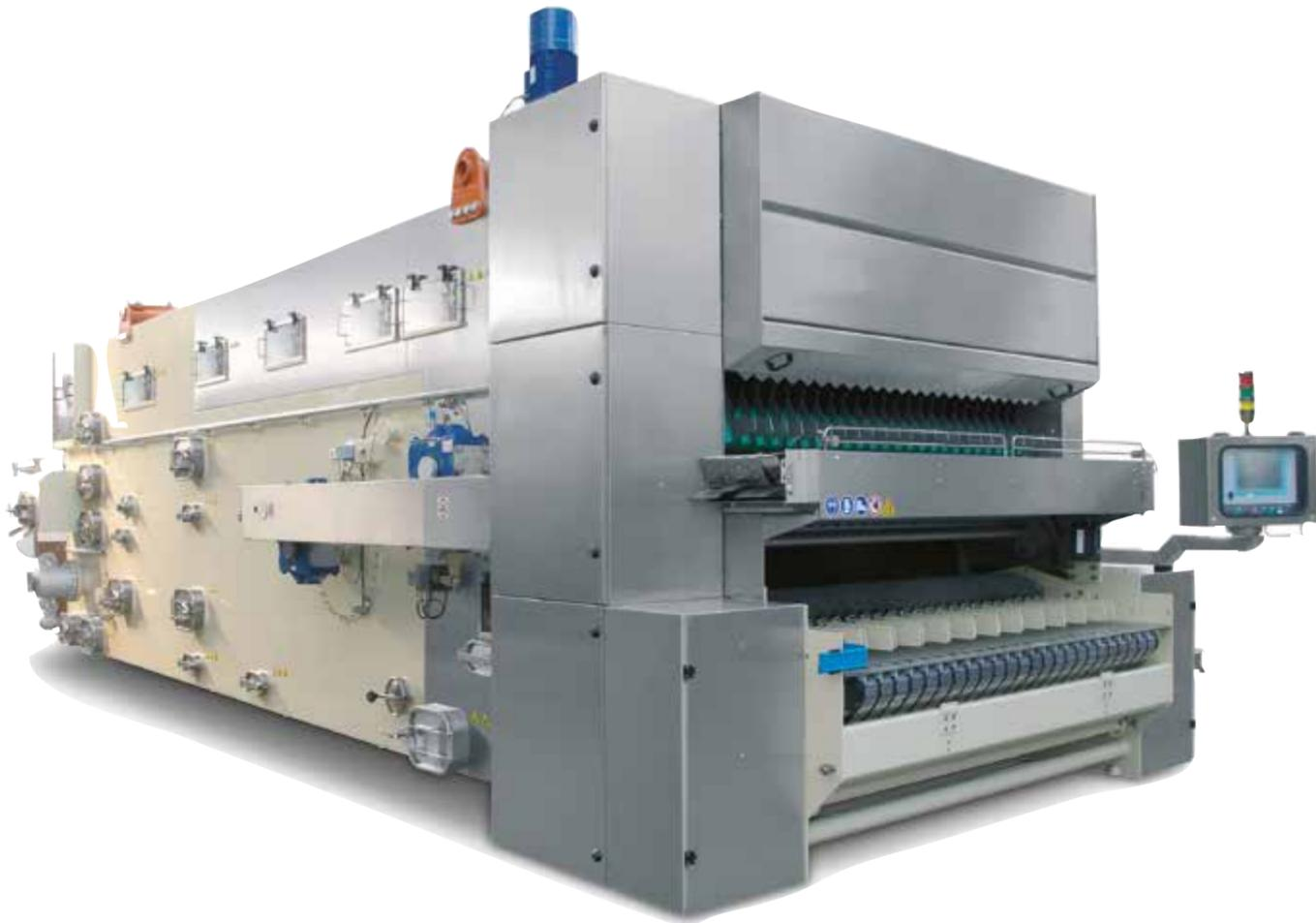
**Die Flaschenreinigungsanlage Aqua wurde für eine niedrige bis mittlere Produktionsmenge (von 30.000 bis zu 120.000 500ml-Flaschen) für den technisch anspruchsvollen Kunden konzipiert.**
