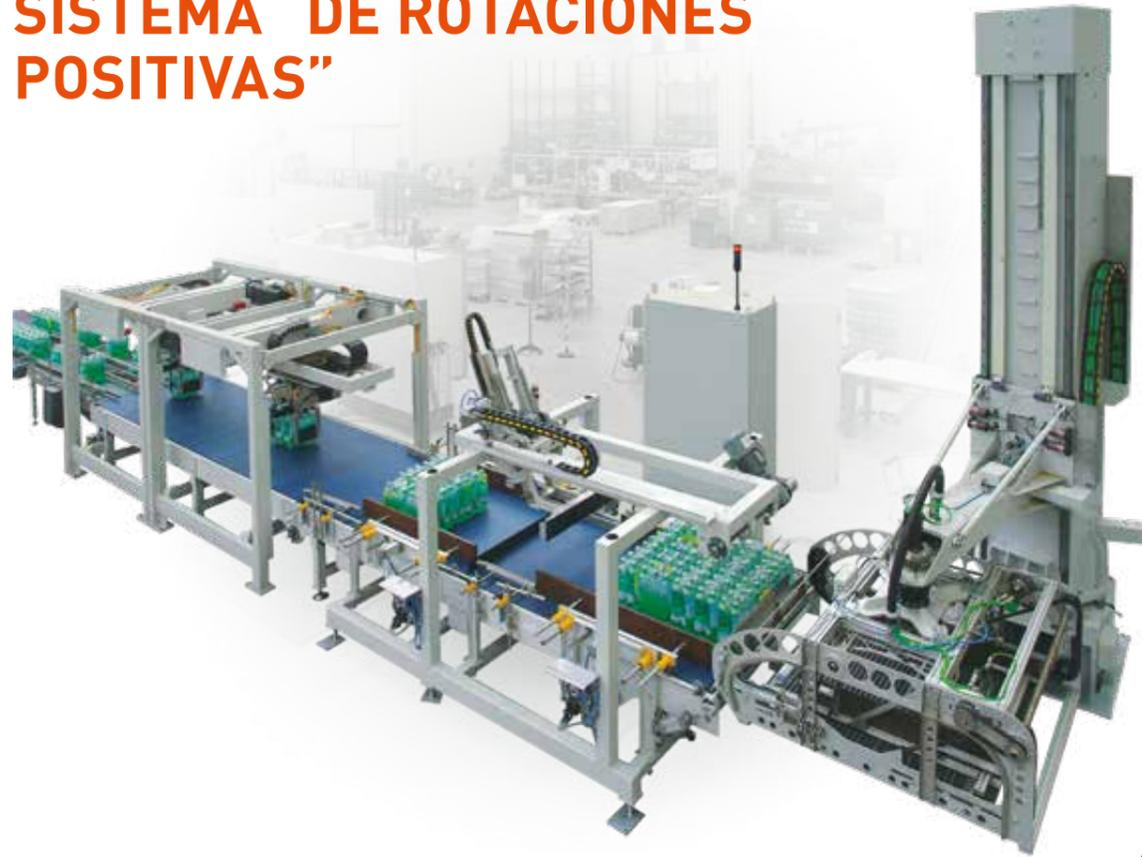
El transportador de cadenas planas garantiza una elevada estabilidad a los paquetes a la entrada ya que su superficie es completamente plana.
