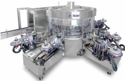
*La etiquetadora rotativa de alta velocidad Sidel SL90 puede pasar rápidamente de las etiquetas autoadhesivas a las etiquetas de cola fría y viceversa*
