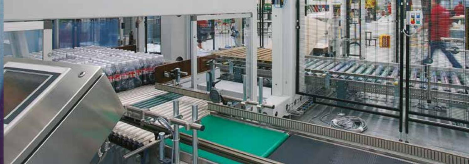
**PalKombi es un paletizador automático idóneo para cajas de plástico, cajas de cartón, bandejas, fardos retractilados y todo tipo de embalajes en general.**
