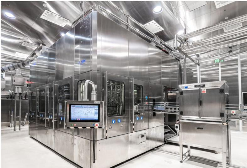
**Die Yili Group, das größte Molkereiunternehmen in Asien, erhielt von Sidel Unterstützung und Know-how, um eine vielseitige aseptischen Lab Abfüllmaschine zu installieren, die in erster Linie für die Forschung und Entwicklung konzipiert wurde und sich im eigens dafür gebauten Werk der Yili Group befindet. Sie wird dem Marktführer der Region gestatten, neue Produkte einzuführen und vorhandene Flaschen anzupassen, um seinen Ruf als innovatives Unternehmen zu festigen.**
