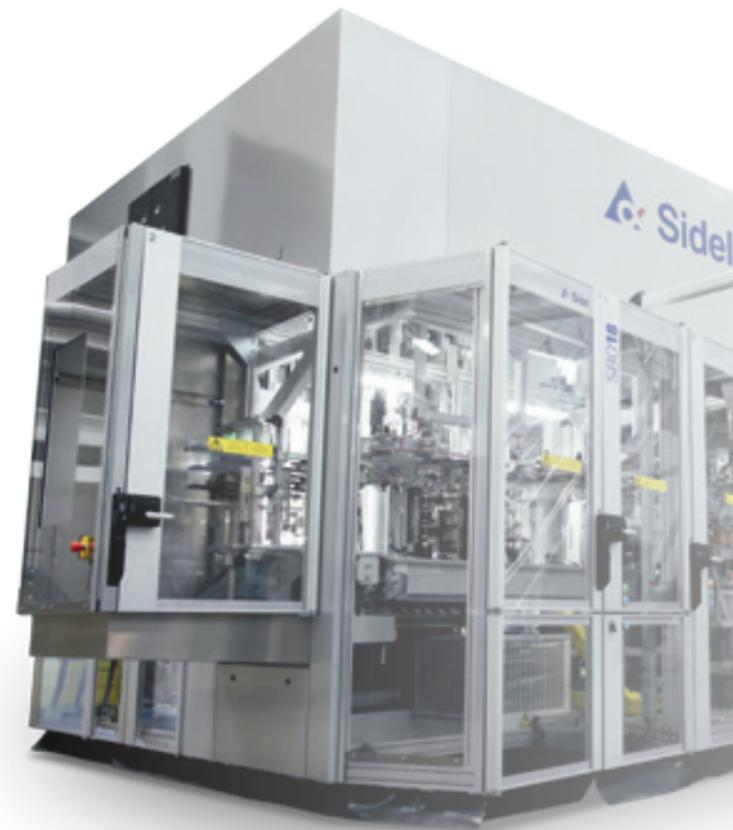
Der effiziente Ecoven ermöglicht mit reduzierter Heizdauer und optimaler Anzahl von Heizmodulen eine Senkung des Stromverbrauchs um bis zu 45 %.
