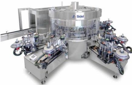
*L'étiqueteuse rotative à grande cadence Sidel SL90 peut basculer rapidement entre les étiquettes autoadhésives et les étiquettes à colle froide.*
