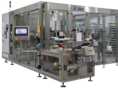
*L'étiqueteuse modulaire Sidel Matrix™ SL70 repose principalement sur l'utilisation de la technologie à bobine.*
