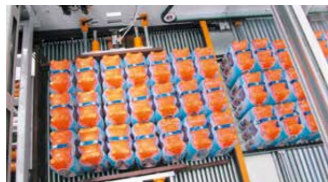
Zona de compactación de capas
