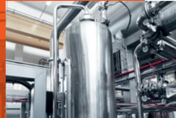
La elevada precisión de la carbonatación es posible gracias a la eficiente tecnología de inyección y distribución del módulo de carbonatación, con un caudal controlado mediante la lectura de los caudalímetros másicos y un mezclado optimizado con la mezcladora estática.
