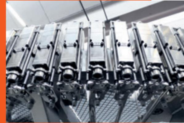
Gracias al control del volumen del caudalímetro magnético, nuestros sistemas flexibles pueden llenar las bebidas de manera precisa, sin desperdicios.
