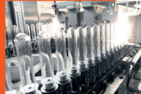
El estirado eléctrico permite una alta velocidad con bajo mantenimiento, mientras aún responde a sus necesidades en términos de flexibilidad de producción.
