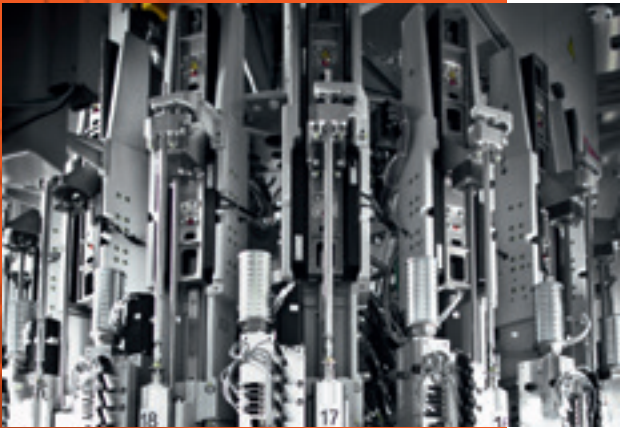
电动瓶胚拉伸系统生产速度快、所需维护少，而且仍可满足生产灵活性需要
