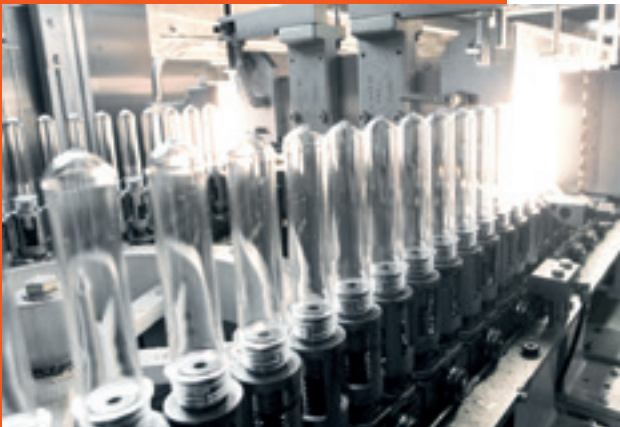
由于缩短了加热时间，配置最佳数量的加热模块，Eco-Oven有着极高的加热效率，可减少电耗达45%
