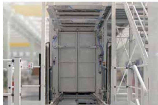
Palettenhebevorrichtung in der Zentraleinheit
