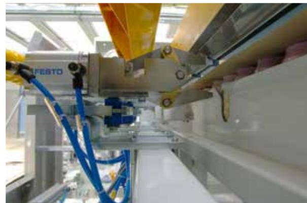
Pneumatische Greifer, die während der Abschiebebewegung die Zwischenlage festhalten
