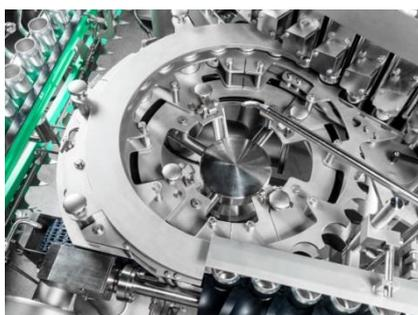
为了达到更高的生产线总体可用性，星轮和导轨采用轻质扇形结构，易于快速更换，不到 30 分钟即可完成换型。
