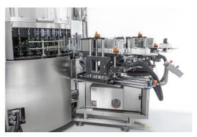
La etiquetadora EvoDECO Adhesive alcanza una velocidad líder en la industria: hasta 66 000 bph.
