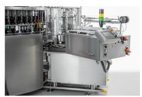
Con su estructura y sus componentes en acero inoxidable, la etiquetadora EvoDECO Cold Glue presenta un diseño higiénico y es completamente lavable.
