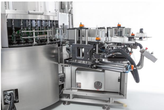
Der EvoDECO PSL-Etikettierer erreicht branchenführende Produktionsleistungen bis 66.000 Fl./Std.
