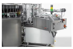
EvoDECO Cold Glue 贴标机采用不锈钢结构和组件,完全可冲洗,确保高度卫生性。
