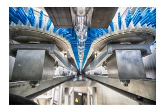
O Sidel EasyFEED™ é um alimentador de preformas inovador, compacto e seguro, instalado no nível do piso e destinado a linhas de produção PET. Inspirado na arquitetura standard do Sidel Matrix™, seu design tem concepção modular. Sua tecnologia patenteada garante a segurança do operador e facilita as operações, graças à redução significativa da área ocupada e da altura necessária para a alimentação de preformas.
