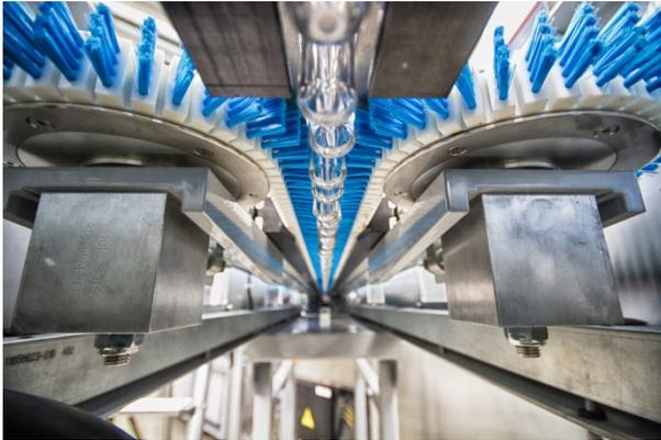
**Sidel EasyFEED™ es un alimentador de preformas a nivel del suelo innovador, compacto y seguro para las líneas de producción en PET. Diseñado sobre la base de la arquitectura estándar de Sidel Matrix™, el sistema ofrece un enfoque modular respecto de la alimentación de preformas. Esta tecnología patentada garantiza la protección del operador y un funcionamiento más seguro al reducir de manera significativa el tamaño del equipo y la altura de la alimentación de las preformas.**
