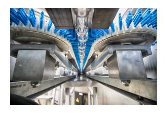
西得乐 EasyFEED™是专用于 PET 生产线的创新型进胚器,安全可靠,结构紧凑,可在地面高度 布置。进胚器基于西得乐 Matrix™标准架构,采用模块化的设计方法。这项专利技术显著降低了 设备占地面积和进胚高度,即保证了操作员的安全性,也方便操作。
