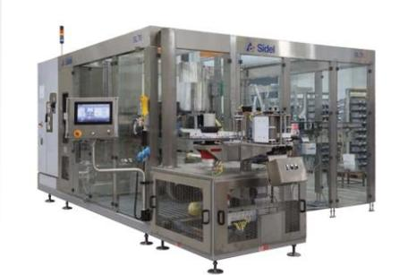
*A Sidel Matrix™ SL70 modular usa principalmente a tecnologia envolvente com bobina (roll-fed)*
