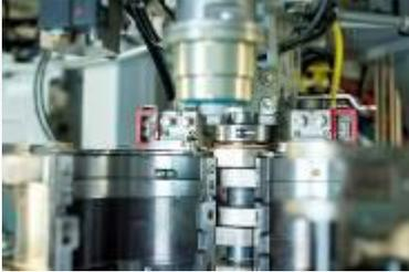
*Eine Wärmedämmung verhindert den Kontakt zwischen den Halbschalen und dem Blasformträger, damit die hohe Temperatur in der Blasform der Sidel Matrix™ eHR bleibt.*
