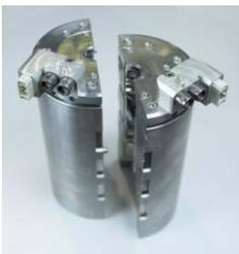
*Die elektrische Erhitzung der Sidel Matrix™ eHR erfolgt in jeder Halbschale mit einem Sensor für die Temperaturkontrolle und Selbstregulierung. Die Solltemperatur wird mit der von dezentralisierten Steuereinheiten bereitgestellten Leistung direkt auf jede Halbschale angewendet.*
