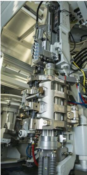
*Durch den Verzicht auf heißes Öl verhindert die Sidel Matrix™ eHR Gefahren durch Ölleckagen wie z. B. Ausrutschen der Bediener oder Verunreinigung der Flaschen.*
