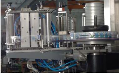
*La bobina de alimentación de película de la Rollquattro Evolution: más espacio del módulo de corte para una operación de etiquetado más delicada.*
