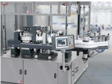
*El soporte de bobina de la Rollquattro Evolution se encuentra estructuralmente integrado en la estación de etiquetado para economizar espacio.*
