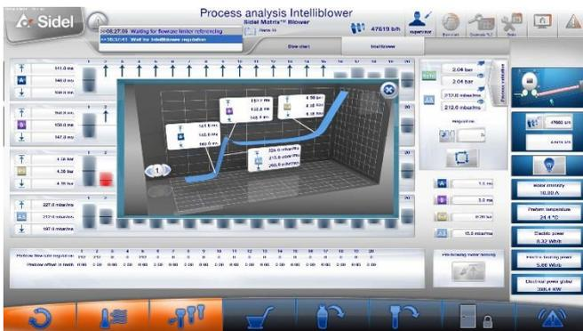
*A Sidel Intelliblower™ elimina a desuniformidade na distribuição do material, através da análise e controle da curva de sopro em cada garrafa PET.*
