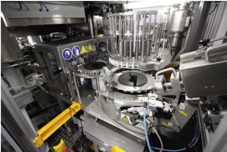
西得乐 Predis™干式瓶胚杀菌技术，现已可用于西得乐最新一代模块化 Matrix™吹瓶机和 Combi 设备。通过这一无菌生产技术系统，饮料生产商既能获得高度的工艺灵活性，又可兼顾可靠性、环保和成本效益。
