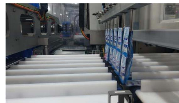
Un module spécifique est implanté en amont de l'encaisseuse sur une ligne de sachets en chapelet pour plier les chapelets. **Le process automatisé existe avec deux types de pliage**, en accordéon pour les chapelets associant des sachets de grande taille et en portefeuille pour des chapelets de petits sachets.
