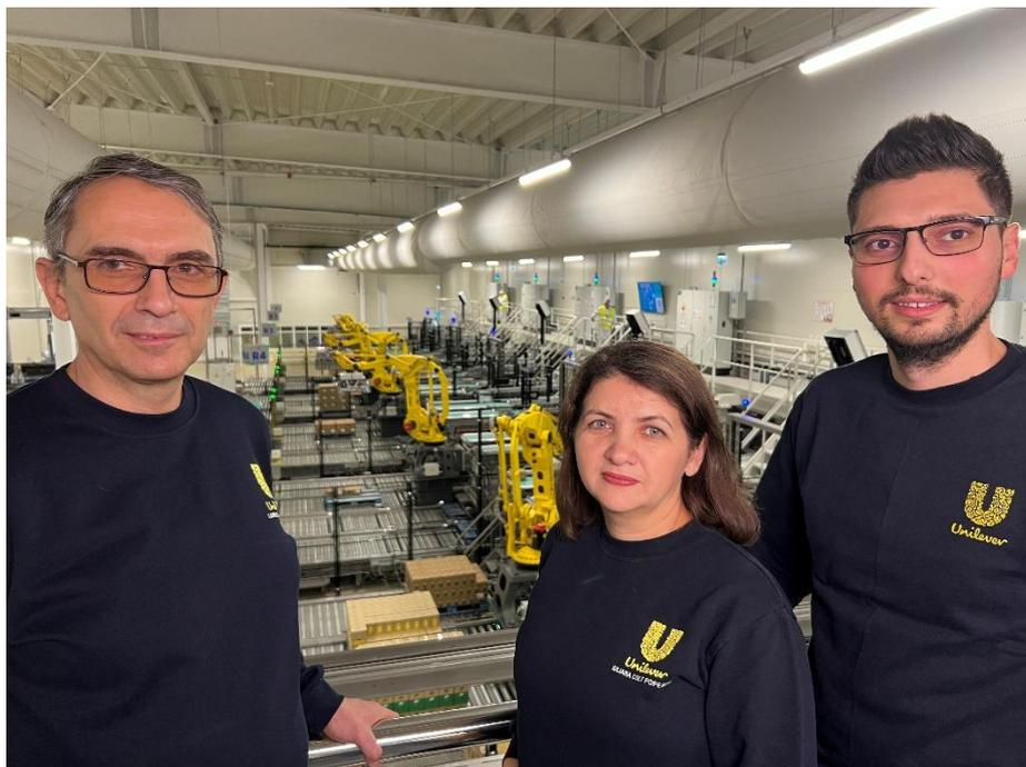
**Sidel a installé un système de palettisation centralisé composé de huit cellules robotisées connectées à 28 lignes d'encaissage sur le site agro-alimentaire d'Unilever à Ploiesti (Roumanie), gérant notamment la fabrication des produits de la marque emblématique Knorr.**
