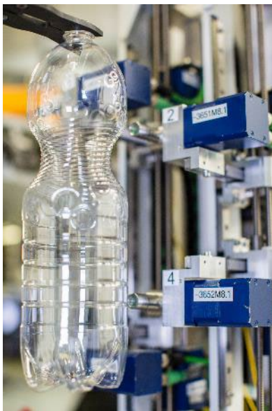
La Figure 1 ci-dessus illustre les mesures haute précision d'épaisseur des parois relevées aux points les plus représentatifs de chaque bouteille, à l'aide de quatre capteurs interférométriques basés sur la lumière infrarouge réfléctée.
