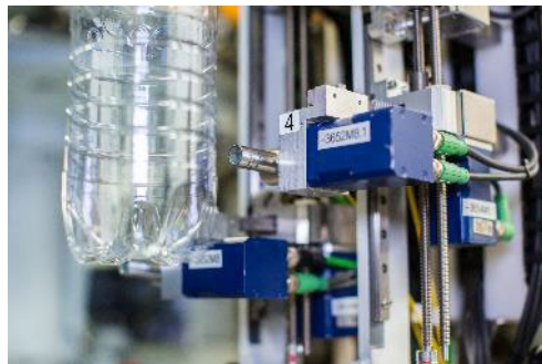
La Figure 1 ci-dessus illustre les mesures haute précision d'épaisseur des parois relevées aux points les plus représentatifs de chaque bouteille, à l'aide de quatre capteurs interférométriques basés sur la lumière infrarouge réfléctée.
