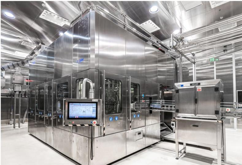
**Yili Group, le plus grand producteur laitier d'Asie, a bénéficié de l'assistance et du savoir-faire de Sidel pour installer une remplisseuse aseptique Lab polyvalente. Cette machine essentiellement conçue pour la Recherche et le Développement est située sur le site dédié de Yili. Elle permettra au leader asiatique de lancer de nouveaux produits et d'adapter des bouteilles existantes, tout en renforçant sa réputation d'entreprise à la pointe de l'innovation.**
