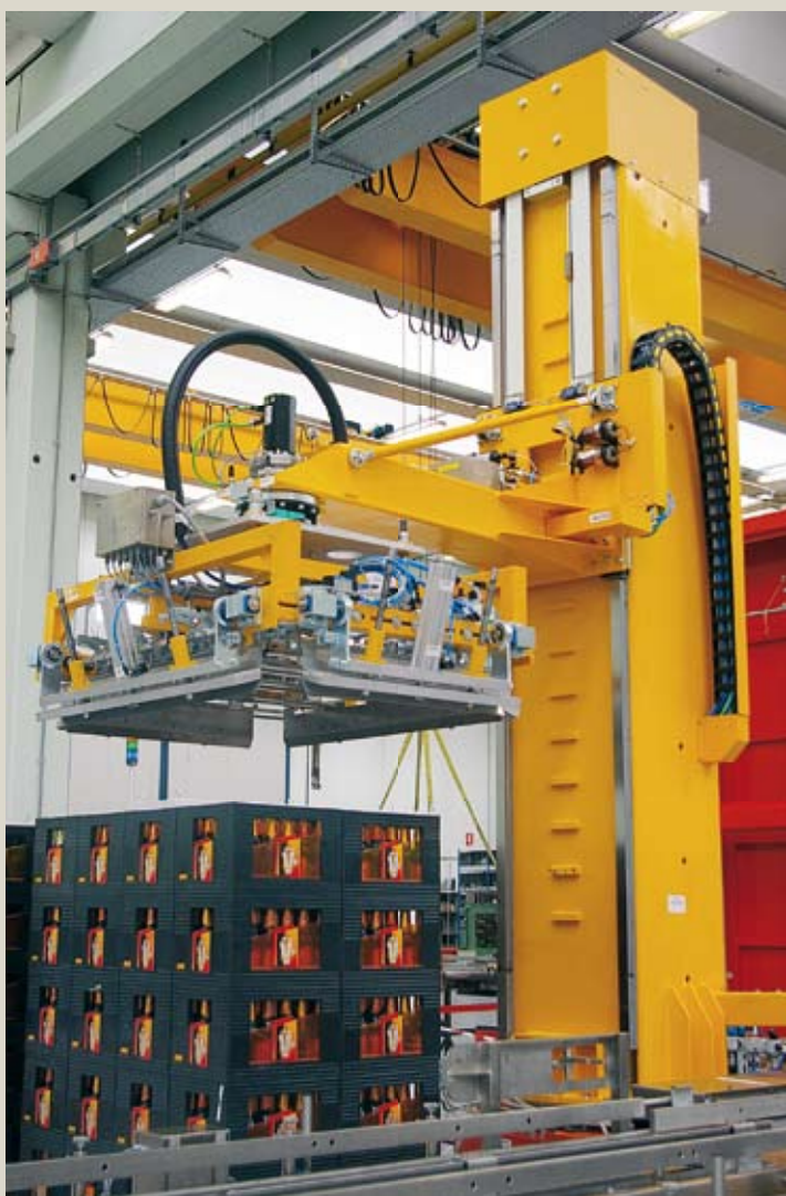
Struttura principale di Robo-Column e braccio di sollevamento in acciaio verniciato
