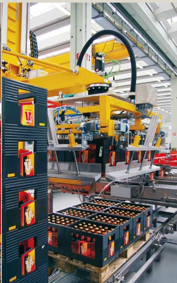
Testa di trasferimento con centratore e ganci per la presa dello strato di casse
