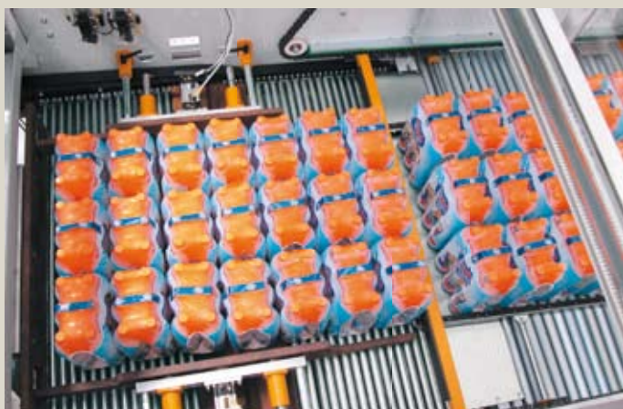
Zona di compattamento strato
