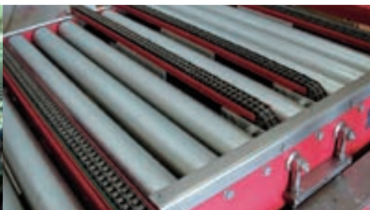
Le tavole di trasferimento garantiscono il cambio di orientamento e di direzione di trasporto dei pallet.
