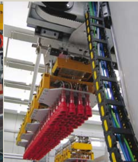
Motorizzazione brushless con cinghie dentate
