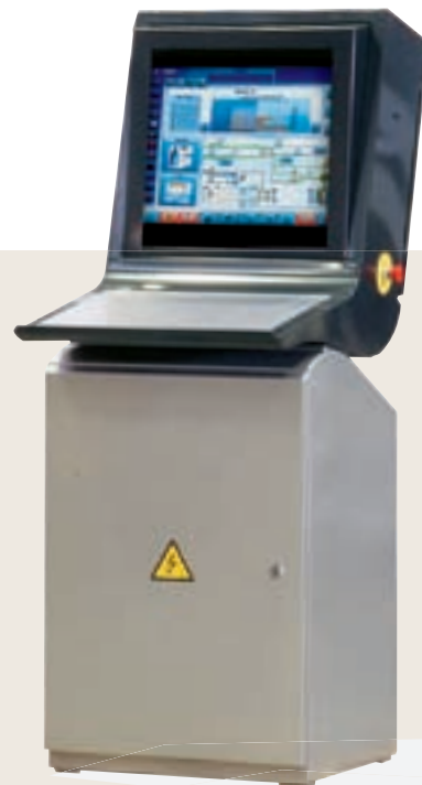
La nuova interfaccia operatore (HMI) della stazione di controllo semplifica la gestione della soffiatrice.
