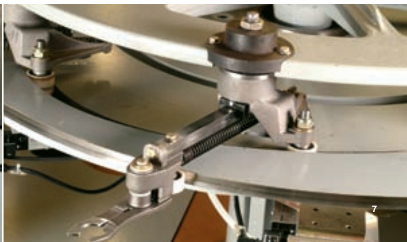
I nuovi bracci di trasferimento contribuiscono a ridurre i tempi di manutenzione.
