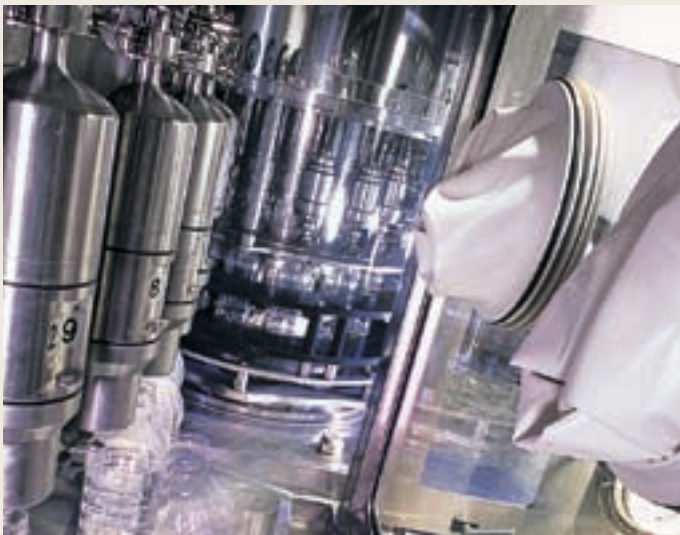
Il Combi può essere equipaggiato di manicotti (scatola per i guanti) per intervenire nella macchina senza aprirla.
