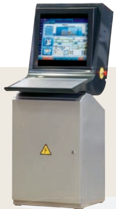
La nouvelle interface homme/machine (IHM) du poste de contrôle simplifie la conduite de la souffeuse.
