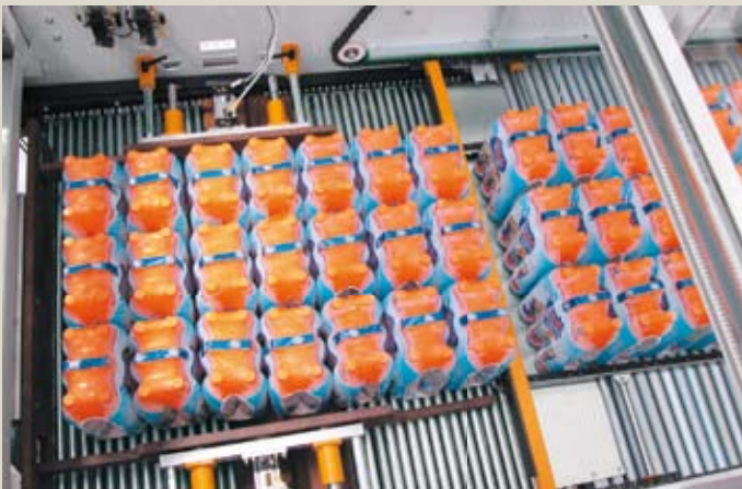
Zone de compactage de couche
