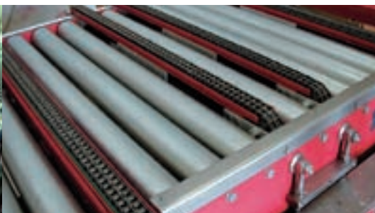
Le changement d'orientation et de sens de transport des palettes est assuré par les tables de transfert.
