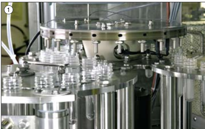
Stérilisation des préformes grâce à la technologie Predis™
