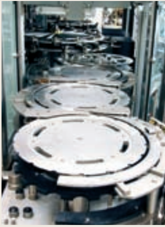
Le concept du Combi repose sur la fiabilité de la cinématique rotative et sur la synchronisation entre soufflage et remplissage.
