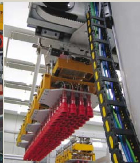
Motorización brushless con correas dentadas
