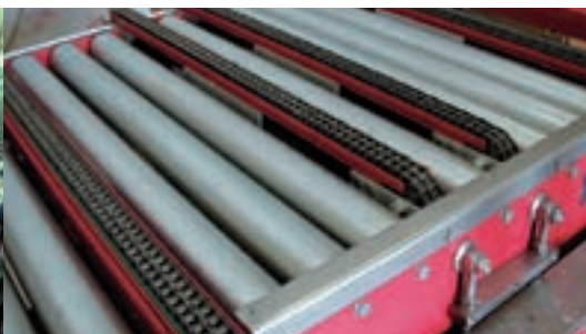
Las tablas de transferencia garantizan el cambio de orientación y sentido de las paletas.
