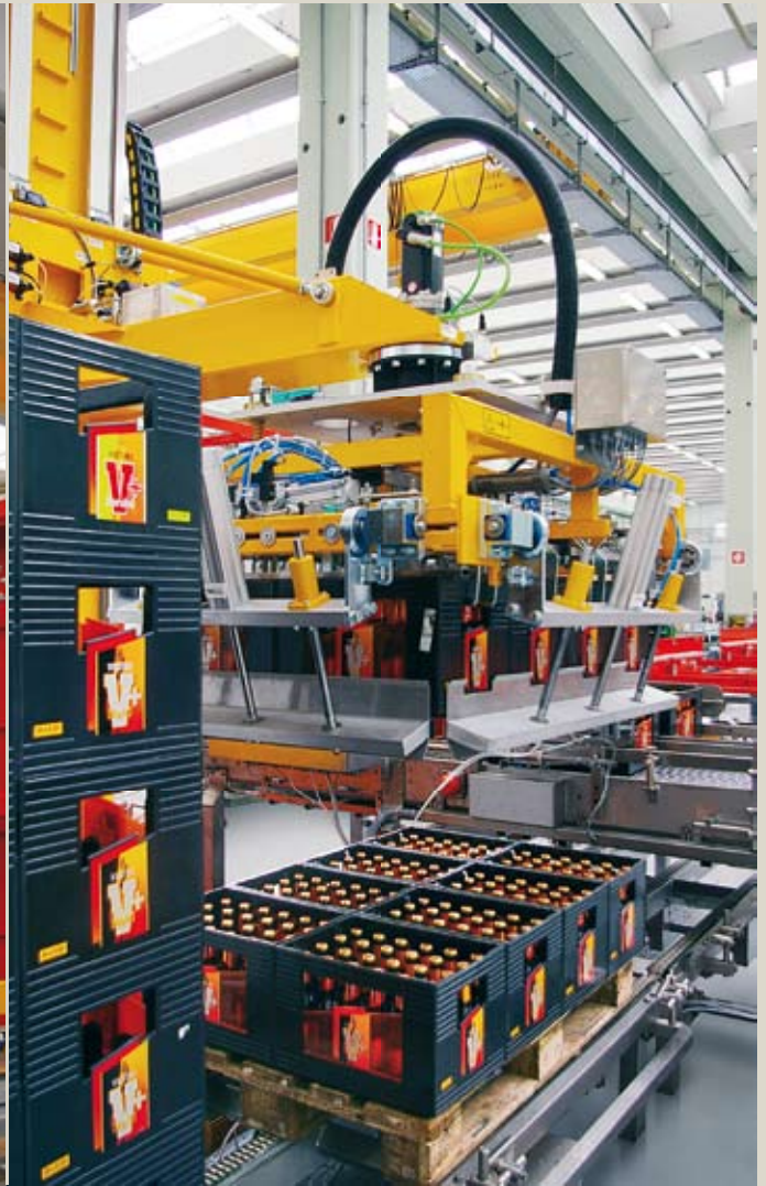
Cabezal de transferencia con dispositivo de centrado y ganchos para la sujeción de los estratos de cajas
