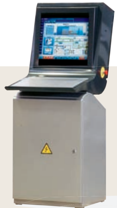
La nueva interfaz hombre/máquina (IHM) del puesto de control simplifica el manejo de la sopladora.
