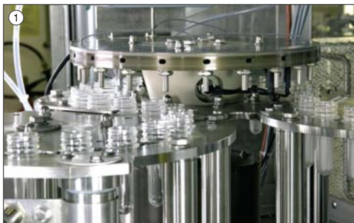
Esterilización de las preformas con Predis™
