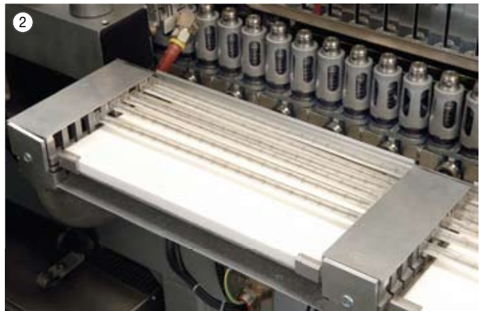
Paso de las preformas en el interior del horno de la sopladora
