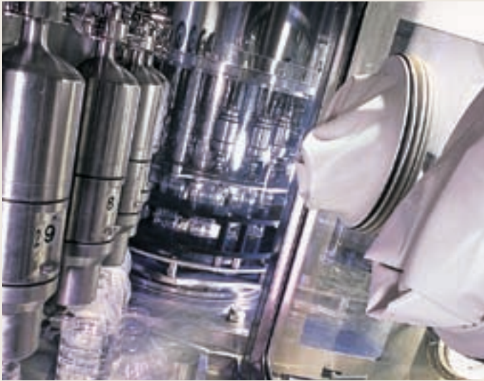
El Combi puede estar equipado con manguitos (guanteras) para intervenir en la máquina sin abrirla.
